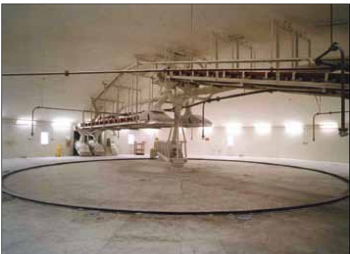
Рис. 5. Подача сахара в силос и загрузка силоса с помощью ленточного транспортера и ковшевого элеватора
