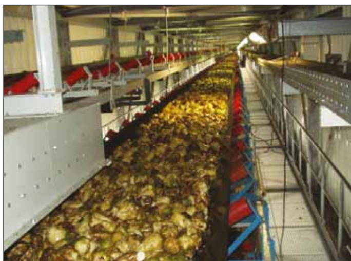
Рис. 1. Ленточные конвейеры для различных процессов: от приемки свеклы до её предварительной очистки
