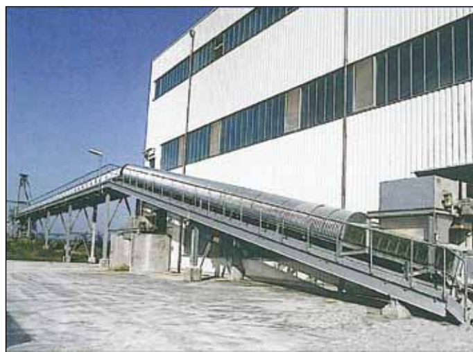
Рис. 3. Транспортировка влажной сатурационной извести с пункта обезвоживания на открытый склад
