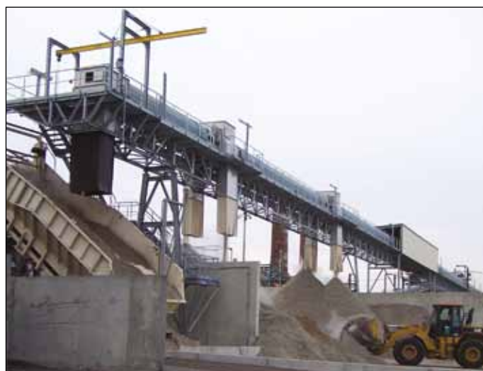
Рис. 2. Ленточные конвейеры, лотковые транспортеры для транспортировки и хранения прессованного жома
