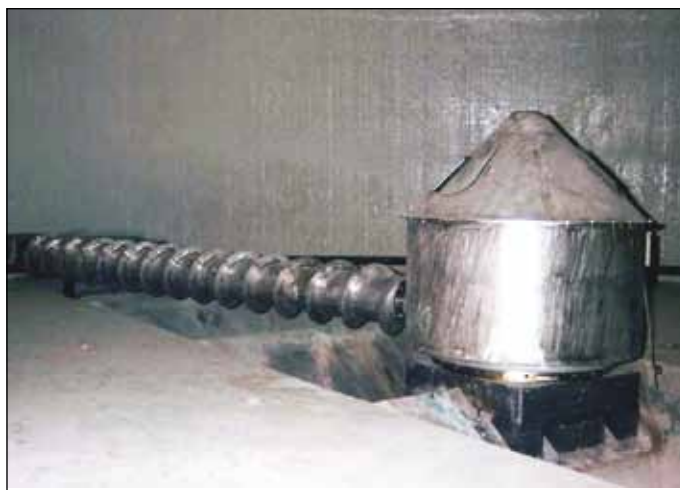
Рис. 6. Опорожнение силоса сахара с помощью заслонки дозатора, подвижных шнековых питателей и ленточных конвейеров
