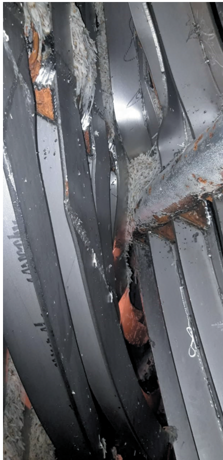
Рис. 2. Фотографии разрушенных витков транспортной системы диффузионного аппарата DC-12
