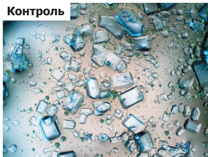
Рис. 5. Утфель I кристаллизации («Контроль»)
