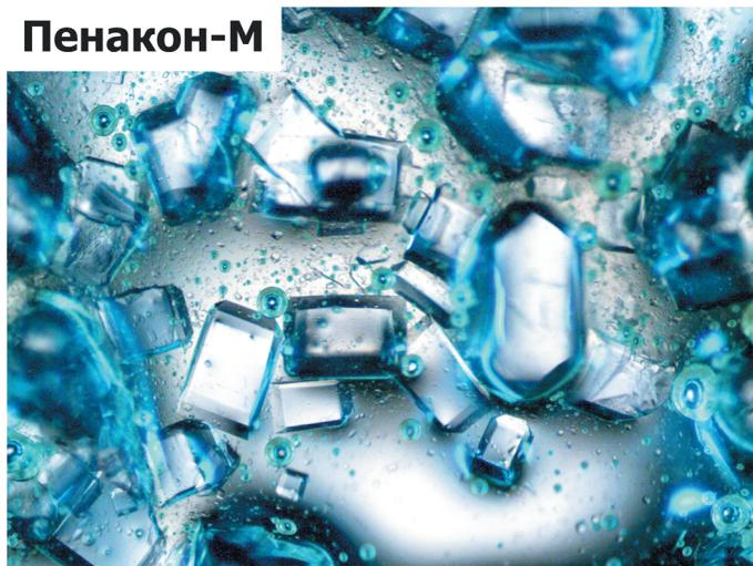
Рис. 4. Утфель I кристаллизации («Пенакон-М»)
