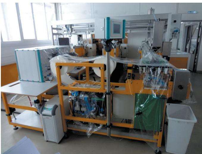
Рис. 2. Участок подготовки проб сахарной свёклы автоматизированной линии Veneta
