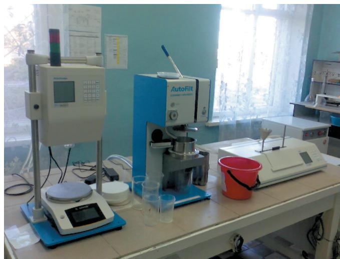
Рис. 5. Участок подготовки пробы свёклы линии MINILAB
