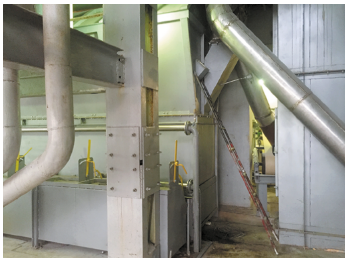
Рис. 6. Аппарат охлаждения сахара-песка с кипящим (псевдоожженным) слоем модели ОКСТП-40С
